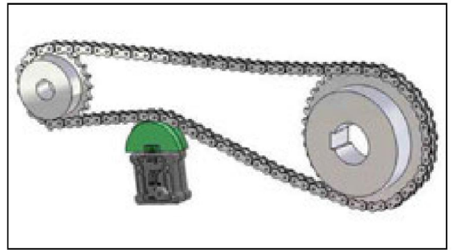
Positionner le tendeur sous la chaîne (ou courroie) au plus près du pignon moteur, sur le brin mou.
